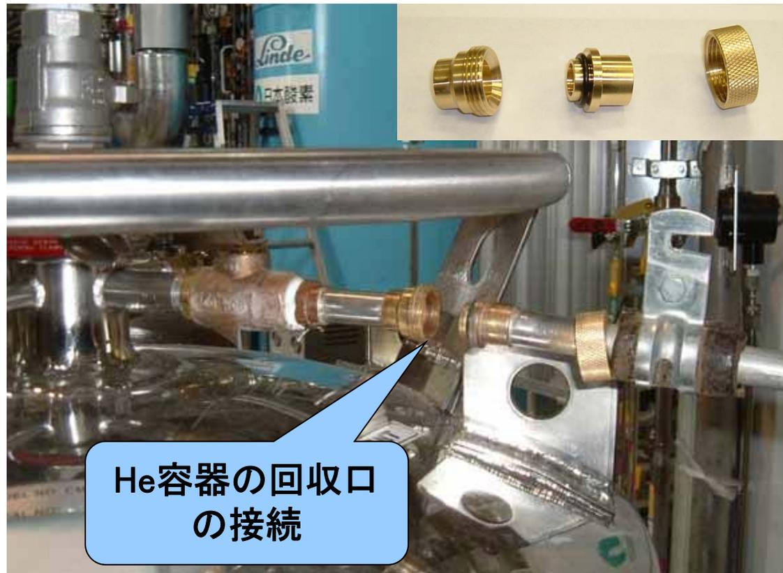
液体He容器の回収口には、写真の右上のカップリングを用いて回収パイプとの接続を行います。新しい容器を購入した際は、低温実験部までご連絡ください。カップリングを提供します。
