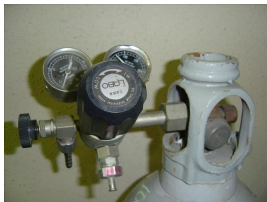
Fig. 23. 窒素ガス（等の一般ガス）用：右ネジ
