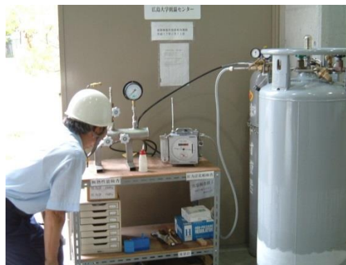
Fig. 25. 法的義務のある密閉型液体窒素容器の検査をしている様子
