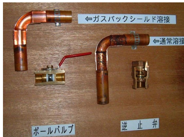
Fig. 27. ヘリウムの回収管工事では 1) ガスバックシールド溶接と 2) 一体型ボールバルブを用いる。
