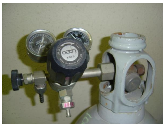
Fig. 23. 窒素ガス（等の一般ガス）用：右ネジ
